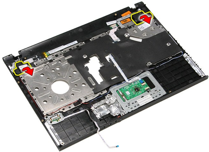
31. حرر كبلات مكبر الصوت من أدلة التوجيه الخاصة بها الموجودة في مسند راحة اليد، وارفع مكبرات الصوت لأعلى بعيدًا عن مسند راحة اليد.
