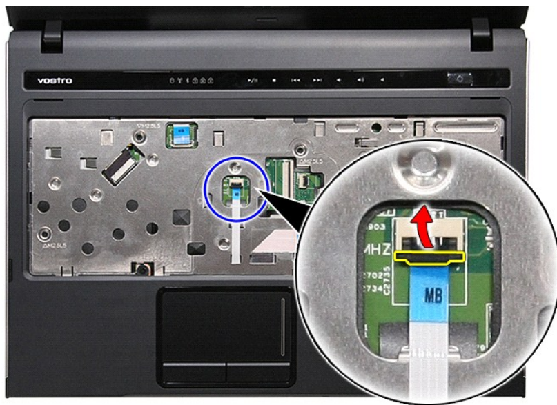
31. الفصل كيل بيئات لوحة اللمس من الموصل الخاص به الموجود في لوحة النظام.
