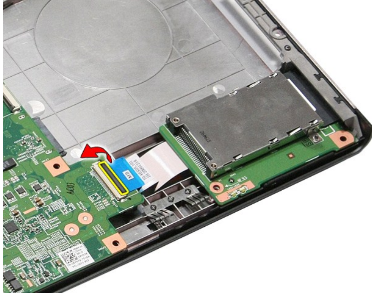
11. الفصل كبل علية ExpressCard من الموصل الخاص به الموجود في لوحة النظام.
