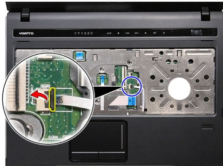
71. اتصل كل قارئ بصمات الأصابع من الموصل الخاص به الموجود في لوحة النظام.
