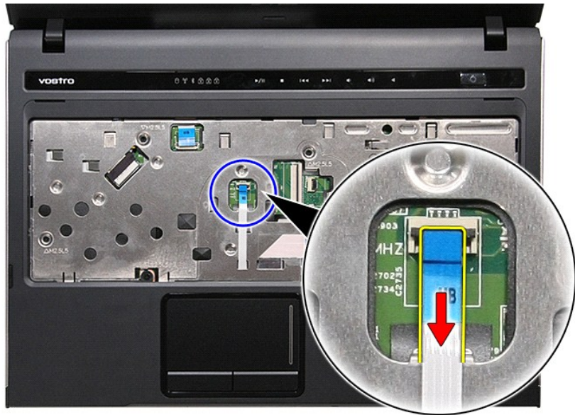
41. افتح المشبك المثبت لكبل بيانات لوحة الصوت في لوحة النظام.
